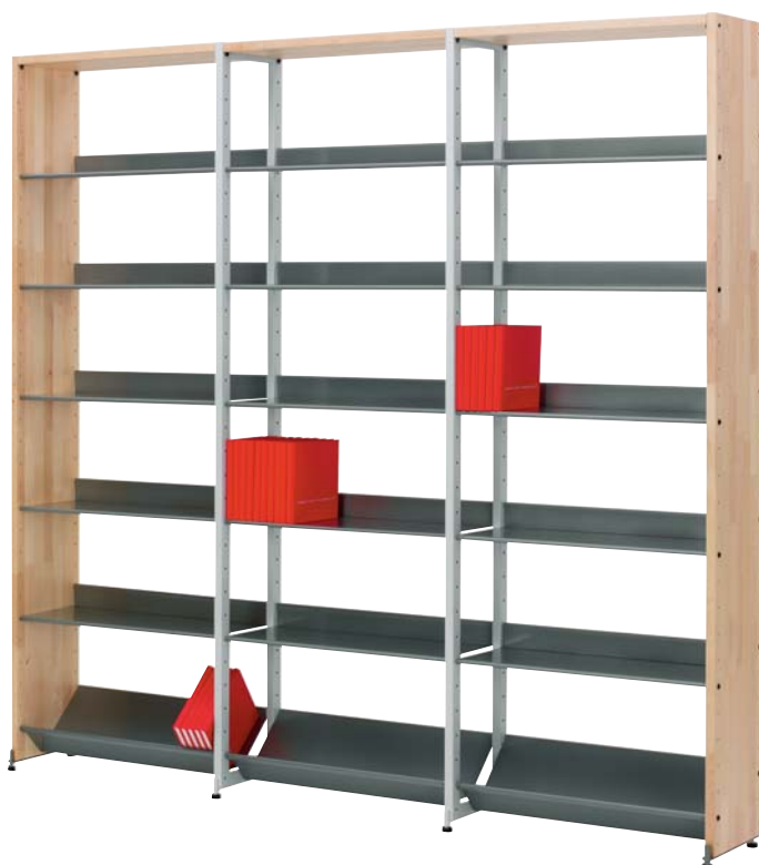
Gavlar i trä och stål, 290x2044 mm. Krönskiva i massiv björk. Hyllplan i stålplåt, pulverlackerad stålgrå. Hyllplanet är vändbart och kan användas plant eller lutande för exponering.
